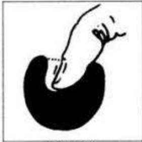
Disegno 1: Dare alla creta la forma di palla, poi ricavare un pozzetto che venga ad assumere l'aspetto di scodella
