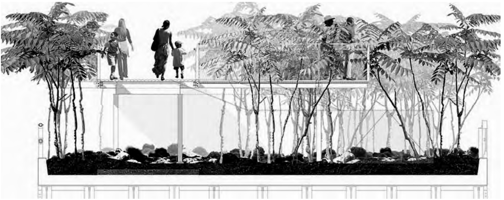
Field Operation, Diller & Scofidio + Renfro, Sezione trasversale del parco dell'High Line nel tratto in cui vengono mantenute la vegetazione e le strutture precedenti all'intervento.
